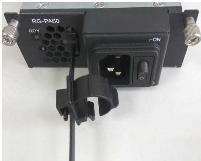
插入电源线，将电源线卡入束线卡扣中，如下图：
