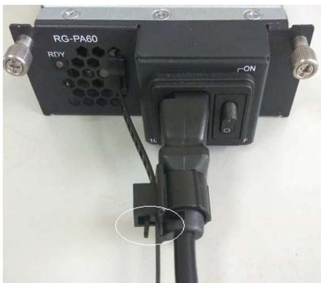
通过图中圆圈标识的弹片可以挪动卡扣位置。
