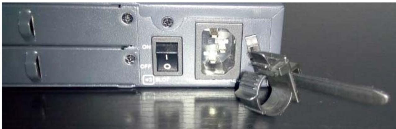
第二步，插入电源线，将电源线卡入束线卡扣中，并通过图中圆圈标识的弹片可以挪动卡扣位置，将束线扣与电源线卡紧。
