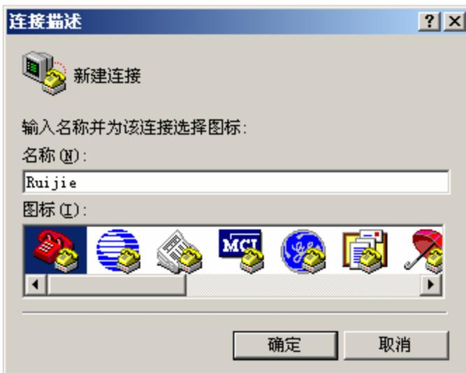
选择和路由器的 Console 连接的微机串口
